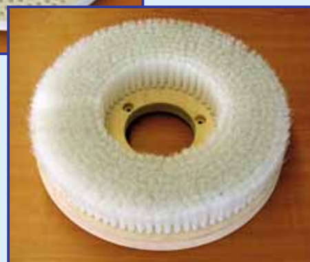
Nově osazený kotouč technologií zarážení
